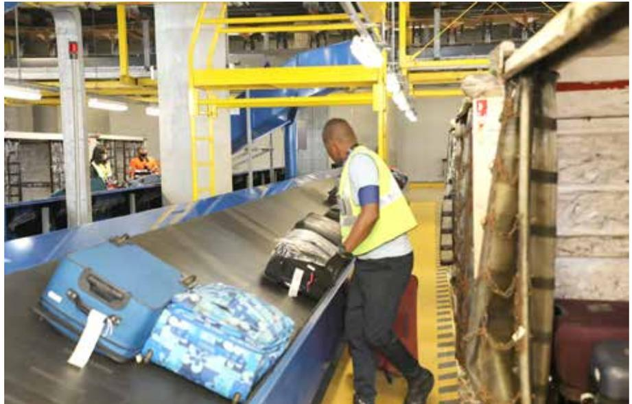
*El Aeropuerto Internacional de Tocumen posee un sistema de manejo de equipaje compuesto por cintas transportadoras y bandejas de alta velocidad.*
