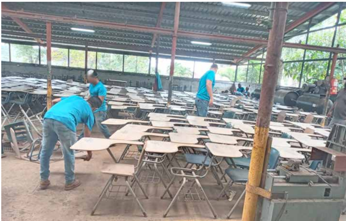
En el taller de ebanistería del centro penitenciario El Renacer las bancas son restauradas con trabajos desde el enderezamiento del hierro hasta la colocación de la madera que las recubre.
